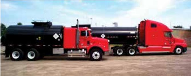
▲ Le Fill-Coat® #1, matériau de remplissage de gaine injecté à chaud, est transporté et réchauffé dans de grands camions citernes.
